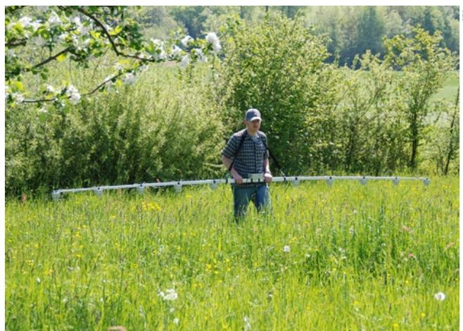
Entdeckt einer der Sensoren eine Wärmequelle, ertönt ein Warn- ton, und auf der Konsole wird im Displayfeld angezeigt, welcher Detektor das Signal gegeben hat. Mit Vorteil wird das Gerät frühmorgens eingesetzt, wenn sich die Körperwärme des Rehkitzes noch deutlich vom kühleren Boden abhebt. Eine Schwierigkeit besteht darin, dass tagsüber auch Maul-
